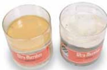
*Muestras para pruebas: el recipiente de la derecha muestra el aceite y el agua no tratados. El recipiente de la izquierda se trató con Ultra-Microbes y muestra solo los lípidos restantes luego de la biorremediación.*
